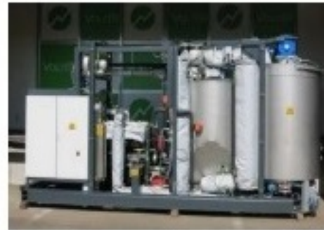
木質バイオマス利用 熱電併給装置
